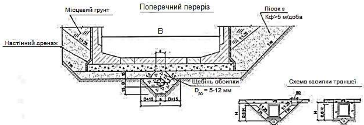
Рисунок А.10 – Варіант дренажу колектора недосконалого типу трапецевидної форми з обсіпанням труби ПЕРФОКОР щебенем
